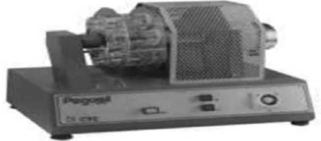
Şekil 3: Su buharı geçirgenlik ölçüm cihazı
