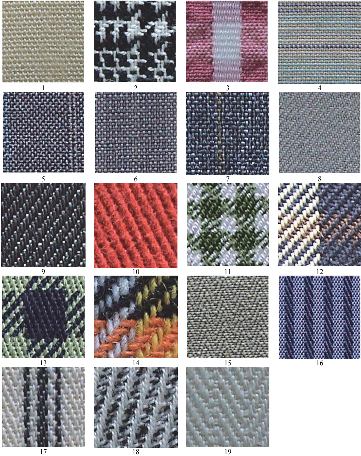
Şekil 1. Bir cm 2 'lik kumaş fotoğrafları: 1-7) bezayağı örgülü kumaşlar, 8-19) dimi örgülü kumaşlar.
