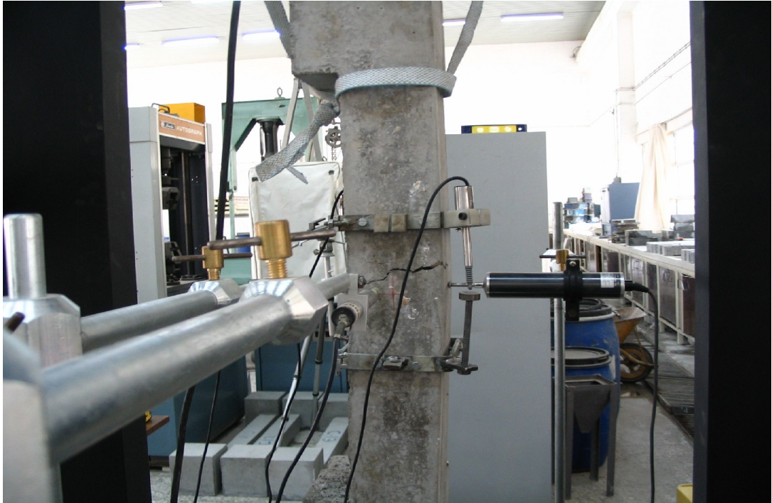
Şekil 6. Betonarme kolon çekme çatlağı
