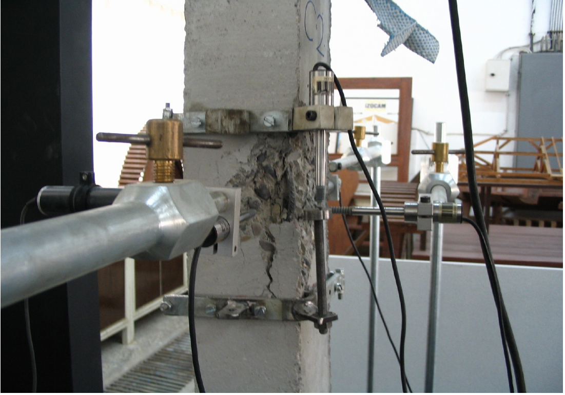
Şekil 5. Betonarme kolon basınç ezilmesi
