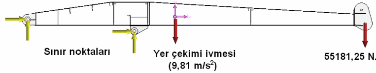
Şekil 5. Kren taşıyıcı kolunun sınır koşulları
