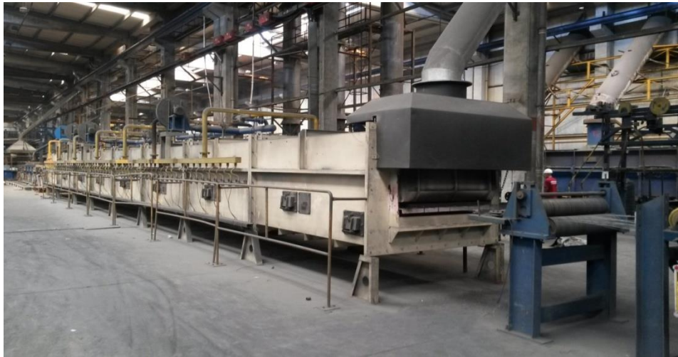
Şekil 1. İşletmede kullanılan galvaniz hattındaki tav fırınından bir görünüm
