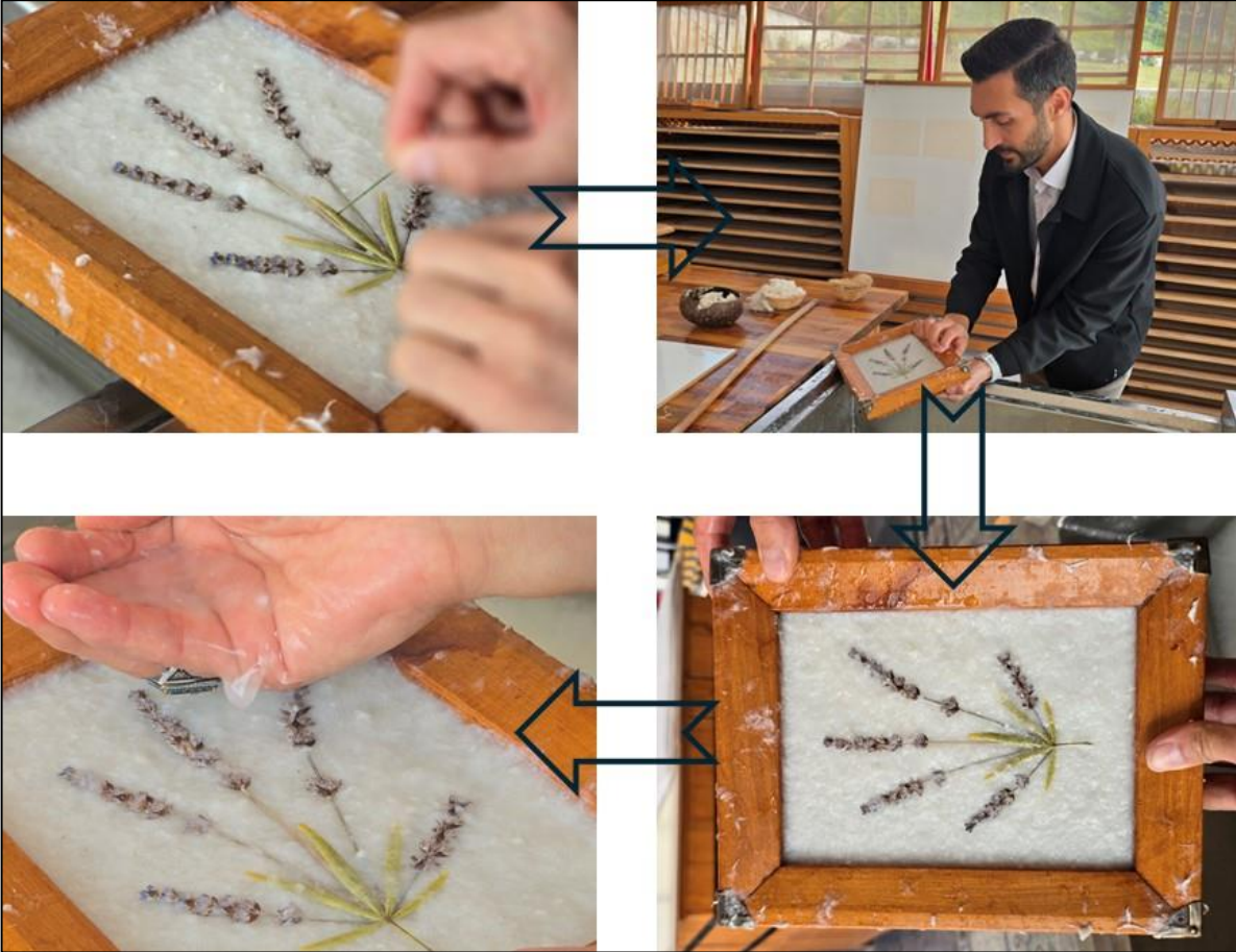
Şekil 5. Islak hamur üzerine yerleştirilen bitkiye ikinci tabaka selüloz serpilmesi ve liflerin bitki dokusuna yapısal entegrasyonu.
