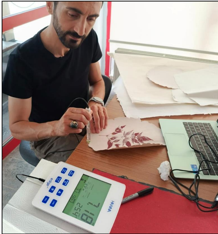
Şekil 8. El yapımı kâğıt örneklerinde gerçekleştirilen pH ölçümü (pH: 7,18).
