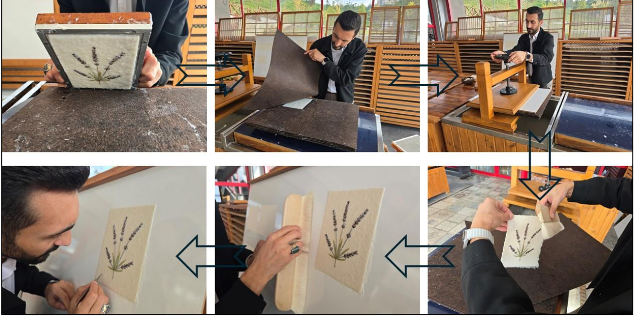
Şekil 6. Presleme aşamasında keçe aralarında istiflenmiş kâğıtlar ve levhalarda kurutma işlemi.
