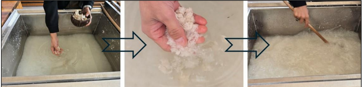
Şekil 3. Hazırlanmış doğal lifli hamurun havuz görünümü ve karıştırılarak lif bağlarının serbest bırakılması.
