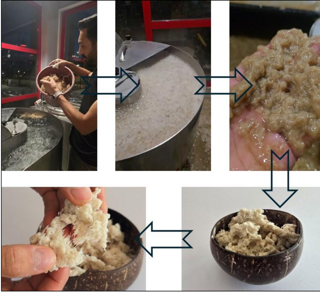
Şekil 2. Hollander dövücüde liflerin hamur hâline getirilmesi ve makro fibrilasyon görüntüsü.
