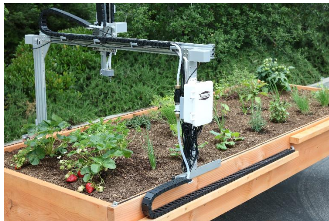
Figure 3- FarmBot robot (Kar et al. 2023)
