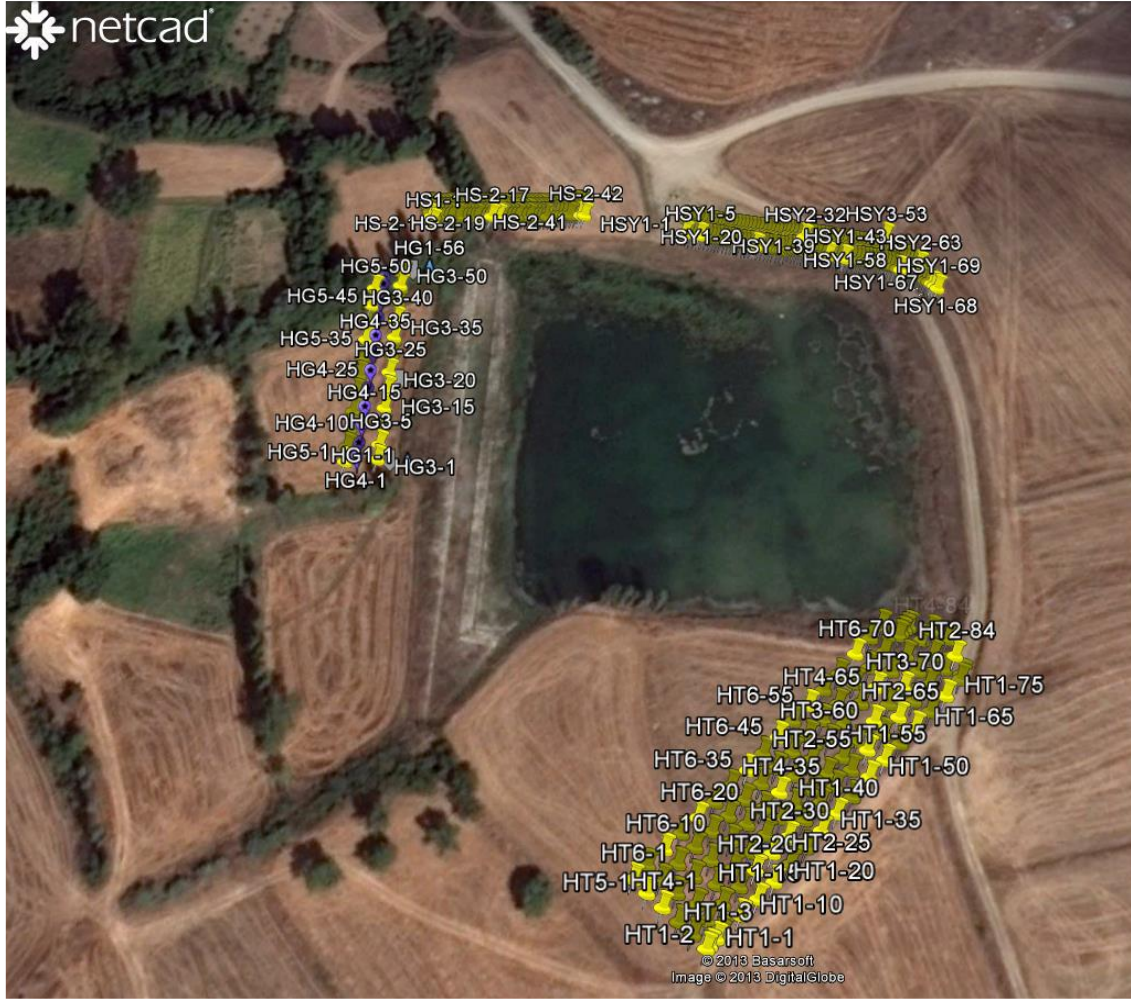
Şekil 10 - Alaca Höyük Hitit Barajı jeofizik tomografi etüdü ölçü hatları [DSİ, 2013]
