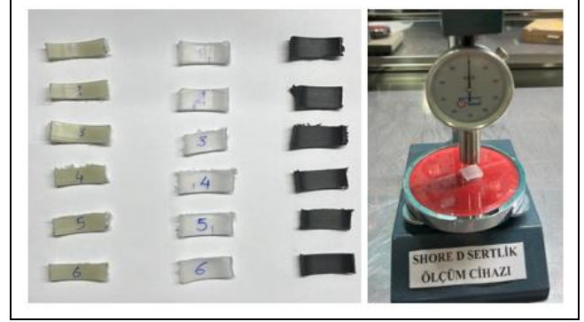
Şekil 6. Test numuneleri ve Shore D sertlik ölçüm cihazı görselleri.
