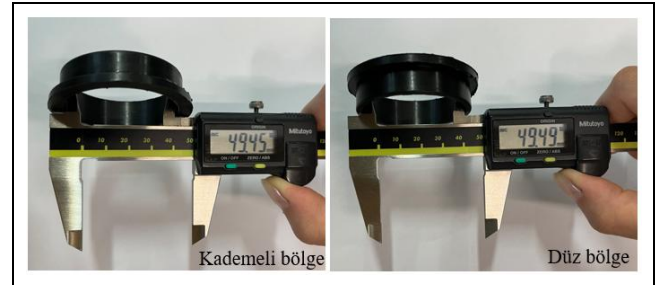
Şekil 13. Dijital kumpas ile iç çap ölçümü alınan bölge görselleri.
